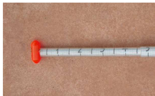
sopra, il dettaglio di un tastatore fissato in cima all'astina con scala millimetrata
